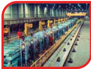
Línea de decapado de acero, ácido al 33%, 80 °C, con partículas de óxido de hierro 120g/litro
